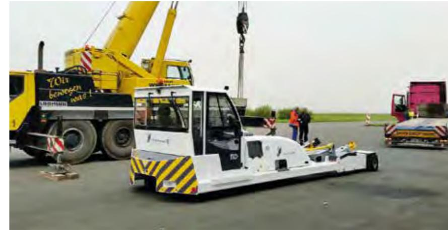
Der Fahrzeugschlepper TPX-100-E vom Hersteller TLD verfügt über einen modernen, elektrischen Antrieb und kann mit einer Länge von knapp 7 Metern, einer Höhe von 2,25 Metern und einem Gewicht von 8,35 Tonnen problemlos Flugzeug-Maschinen bis zu 100 Tonnen bewegen. Die Nutzungsdauer des Elektro-Fahrzeugs beträgt ca. acht Stunden.
